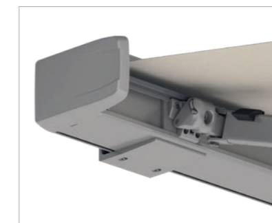
Das Kippgelenkarmlager mit Hochschlagsicherung ermöglicht ein sicheres Schließverhalten und verhindert das Hochschlagen bei Windböen.
